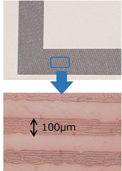
150µm未満の細線を安定的に印刷可能
